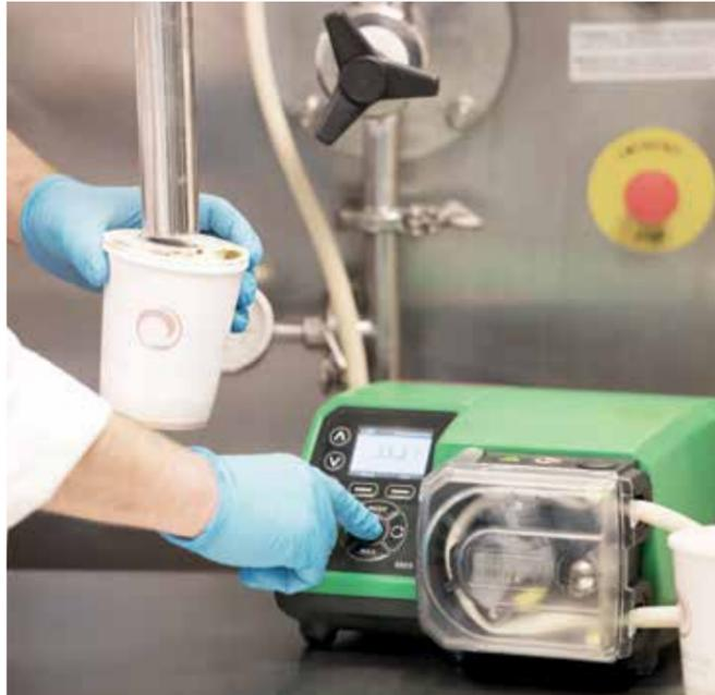
As bombas peristálticas são capazes de transferir fluidos agressivos e sensíveis ao cisalhamento. O fluido bombeado é completamente contido dentro da mangueira, criando um isolamento total do fluido e eliminando contaminações cruzadas.
